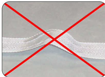
Pose non conforme
