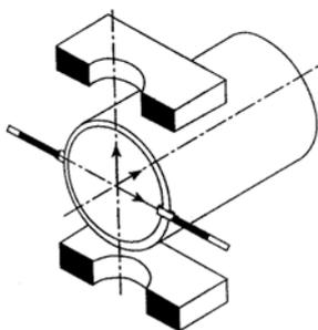
La loi de Faraday sur l'électromagnétisme énonce que la tension induite par un conducteur quand il se déplace dans un champ magnétique, est proportionnelle à sa vitesse.
