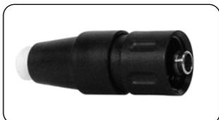
Pour raccordement des câbles 9060 sur tous les pH/mV-mètres et tête d'électrode S7. Ce connecteur breveté présente l'avantage d'être montable sur site avec les câbles ci-dessous sans outillage spécial si ce n'est un fer à souder et une pince à dénuder.
