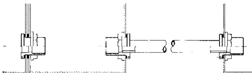
Raccordement de réservoir
